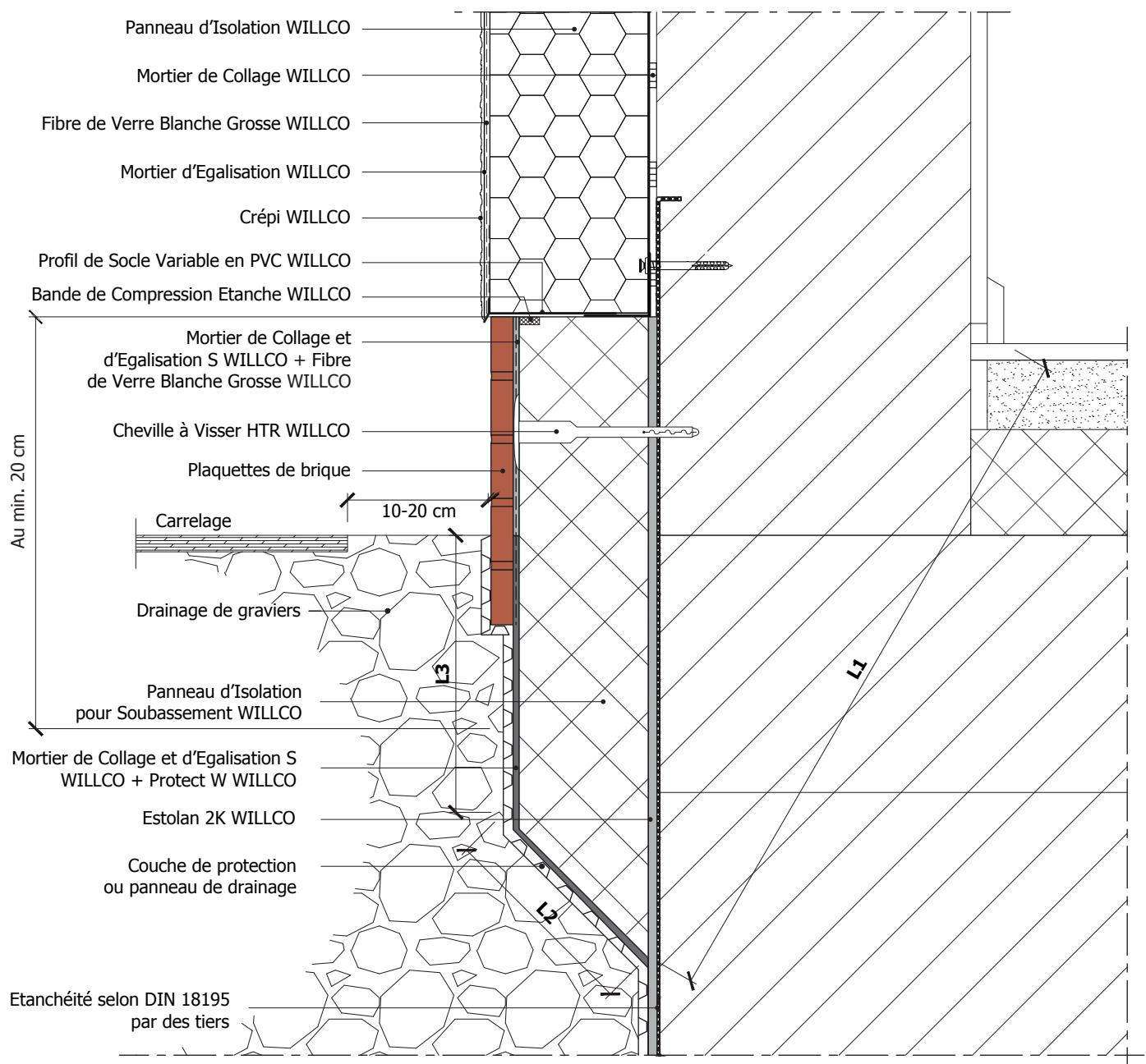
Ce détail de principe est une représentation schématique d'un système d'isolation de façade extérieure. Les raccords avec des matériaux étrangers sont eux aussi représentés de manière schématique. La situation réelle peut différer de cette représentation. Ce schéma de principe détaillé sert de fil conducteur mais doit être éventuellement adapté par l'installateur en tenant compte avec la situation réelle.
