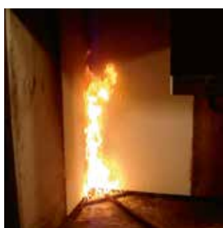
Fig. 26: Essai de réaction au feu
