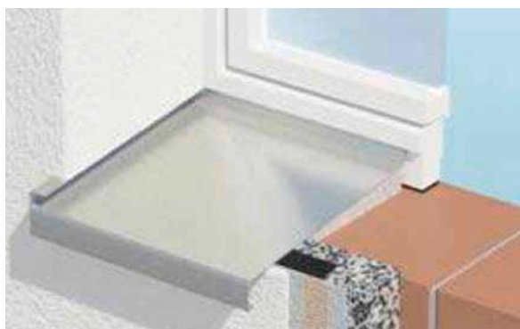
Fig. 36: Exécution des détails avec bande d'étanchéité
