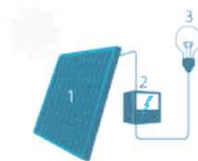
1. Zonnepaneel 2. Omvormer 3. Lichtbron
