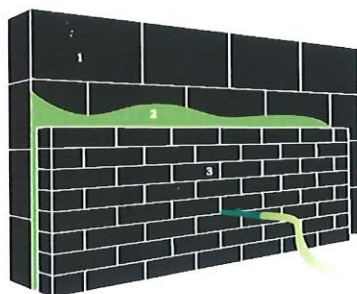
1. Dragende muur | 2. Ingeblazen isolatie | 3. Gevelsteen / gevelbekleding
