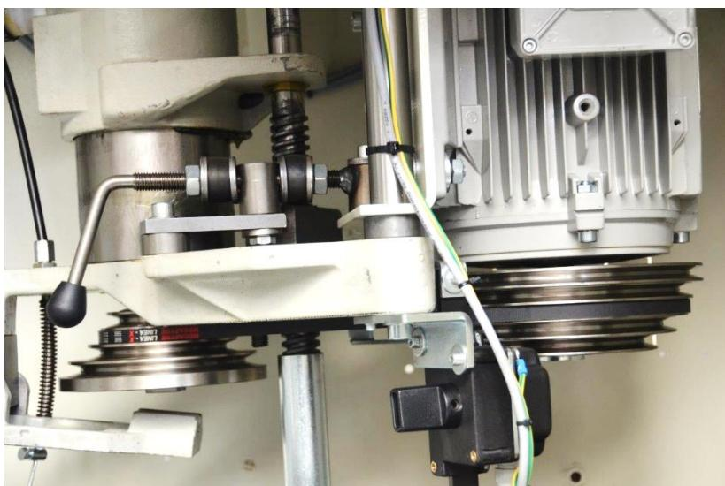
Le moteur et l'arbre de toupie sont équipés d'une poulie à courroie avec de différents degrés. Ainsi nous arrivons à 5 vitesses sur l'arbre de toupie: 3000/4500/6000/7000/10000 rotations par minute.
