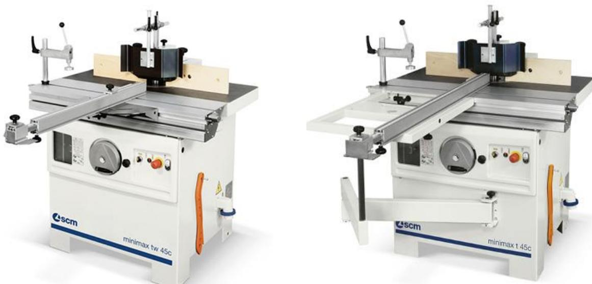
**c) table à tenonner latérale avec guide (en aluminium) réglable diagonalement et presseur excentrique + dispositif anti-éclat**
