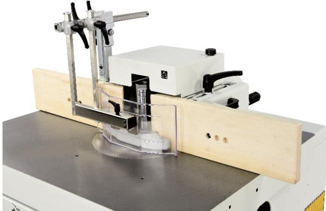
b) Guide de toupie avec programmation mécanique et un diamètre d'outils maximal de 250 mm.
