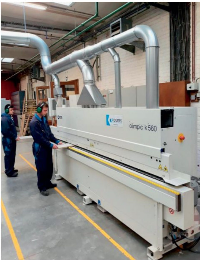
L'investissement le plus récent du VTI Waregem est une encolleuse de chants de haute technologie SCM Olympic k 560 HP de Rogiers
