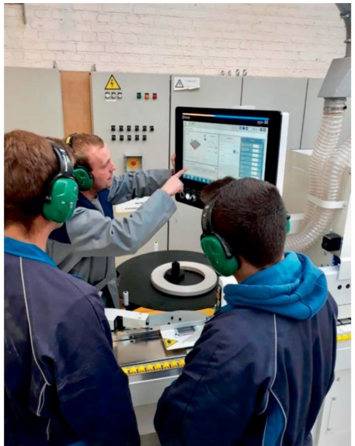
L'investissement le plus récent du VTI Waregem est une encolleuse de chants de haute technologie SCM Olympic k 560 HP de Rogiers
