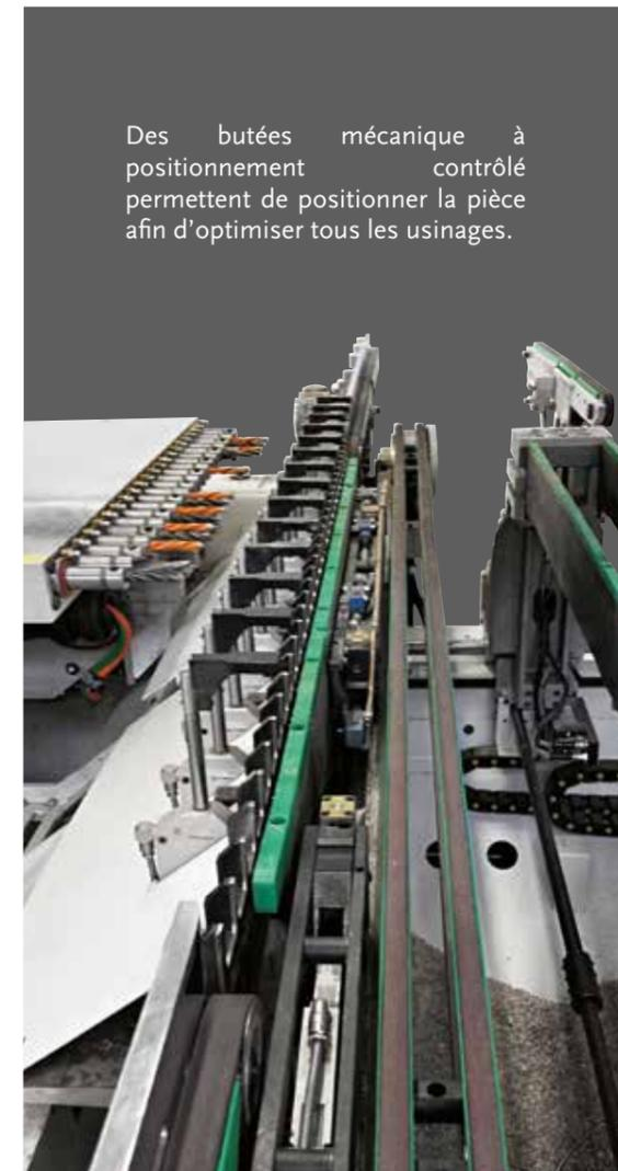
**Jusqu'à 10 presseurs intégrés** aux têtes de perçage à aspiration intégrée complètement automatiques et indépendants.
