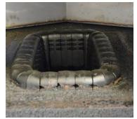
La grille de combustion en forme de bol est construite d'éléments en fonte assemblables. Les ouvertures ingénieuses dans le moule donnent la possibilité d'ajouter la quantité exacte d'air primaire dans le foyer pour créer ainsi une combustion parfaite. Une durée de vie longue de la chambre de combustion est garantie. Elle est construite d'un acier certifié UNI EN 303-5. L'épaisseur du paroi est de 4 jusqu'à 8 mm dépendant de la capacité.
