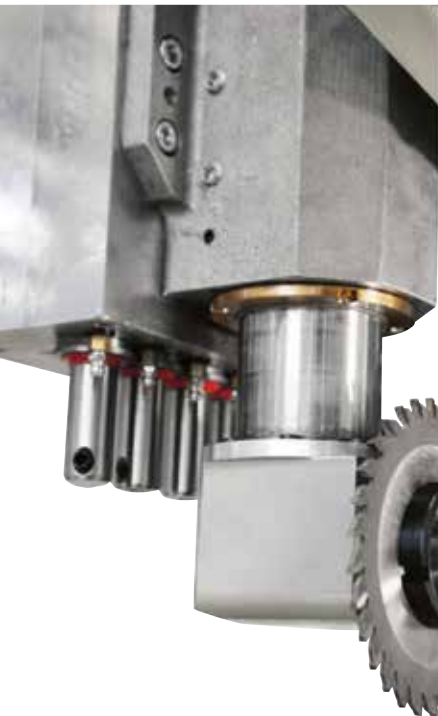
Exécution facile des découpes et des rainures en direction X et Y, grâce au groupe lame 0°-90°.
