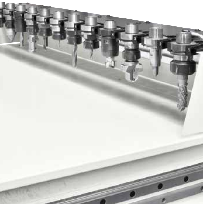
Magasin latéral TRB jusqu'à 19 emplacements.
