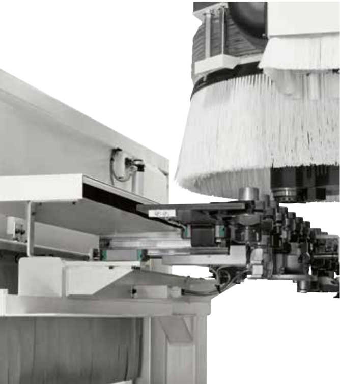
* Pour toutes les versions , le magasin "Pick-up", embarqué sur la traverse, est disponible. Agencement idéal pour l'utilisation d'outils et de têtes à renvoi d'angle encombrants.
