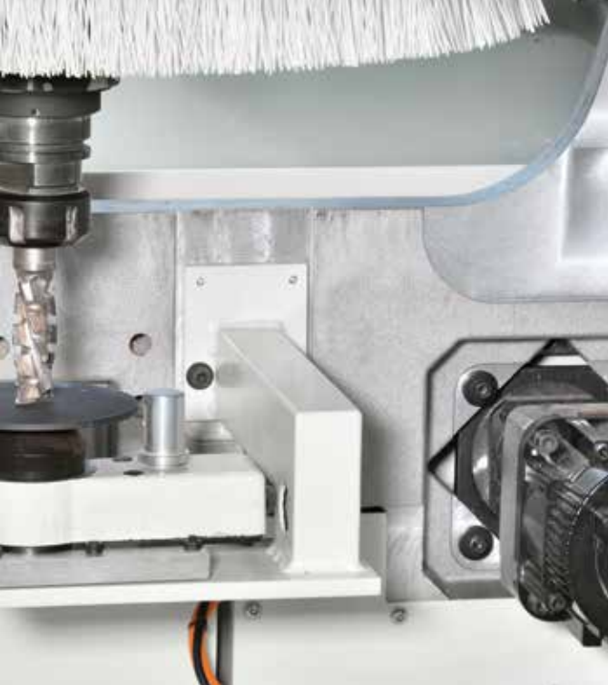
MESUREUR AUTOMATIQUE D'OUTIL Monté à côté du bâti, il permet de mesurer automatiquement la longueur de l'outil.
