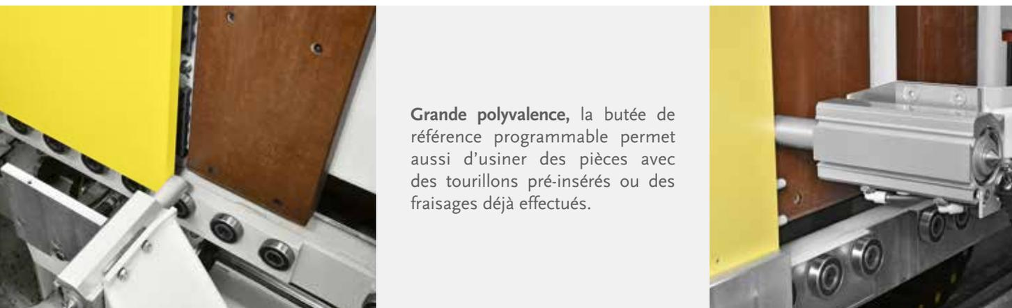
**Grande polyvalence,** la butée de référence programmable permet aussi d'usiner des pièces avec des tourillons pré-insérés ou des fraisages déjà effectués.
