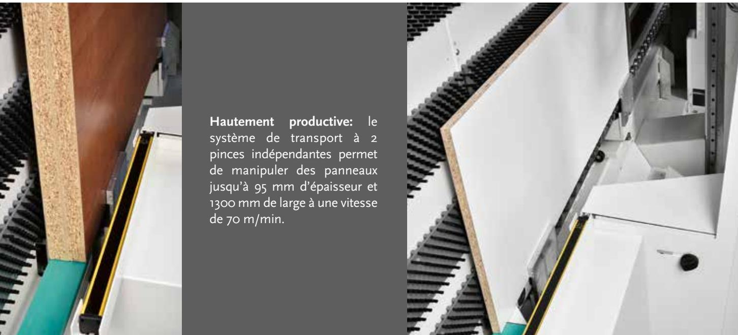
**Hautement productive:** le système de transport à 2 pinces indépendantes permet de manipuler des panneaux jusqu'à 95 mm d'épaisseur et 1300 mm de large à une vitesse de 70 m/min.
