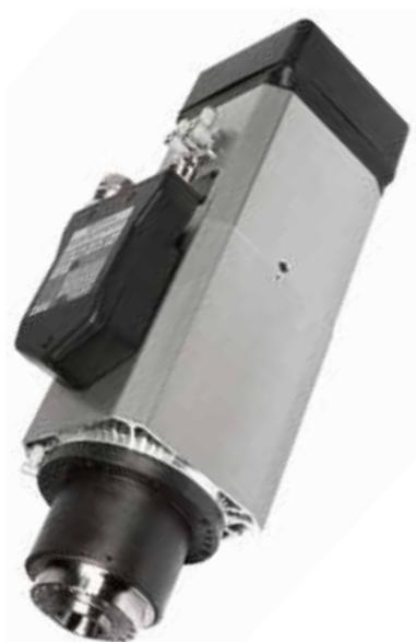
**Performant et fiable**, l'électrobroche de 6,6 kW à raccord HSK63-F, vitesse de rotation jusqu'à 24.000 tours/min, est la solution idéale pour l'exécution de fraisages localisés sur différents types de panneaux. Positionné sur la tête supérieure, il permet de réaliser des fraisages borgnes et débouchants.
