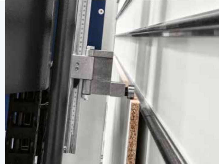
Dispositif pour les coupes répétitives horizontales
