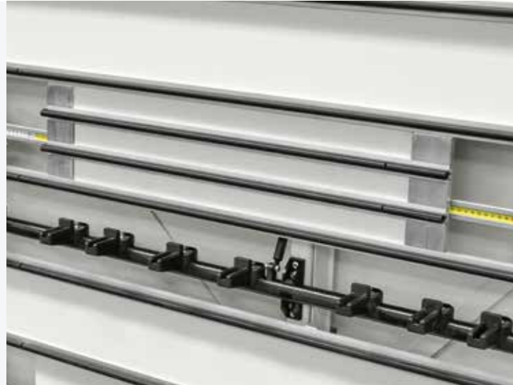
Support coulissant pour les pièces étroites
