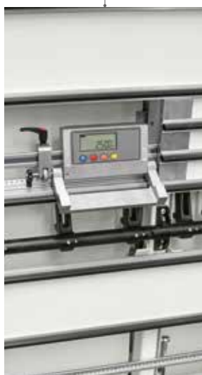
Lecteur digital pour les dimensions verticales (opt. v, vs, vsi)
