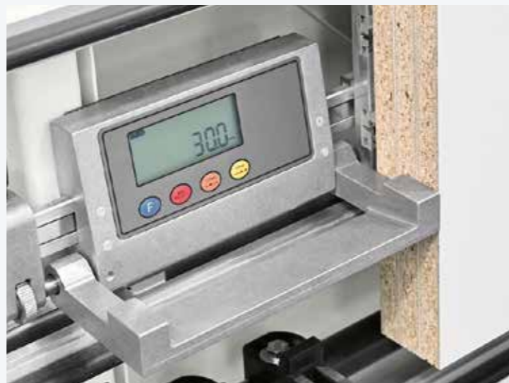
Lecteur digital pour les dimensions verticales
