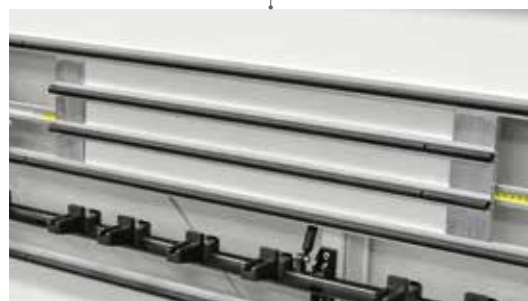
Support coulissant pour les pièces étroites (opt. v, vs, vsi)
