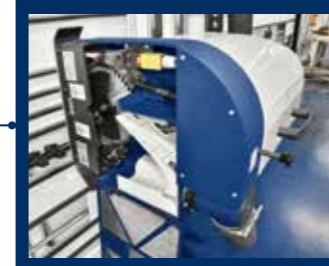
Chariot lame avec lame principale et inciseur à moteurs indépendants
