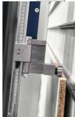
Dispositif pour coupes répétitives horizontales (opt v, vs, vsi)
