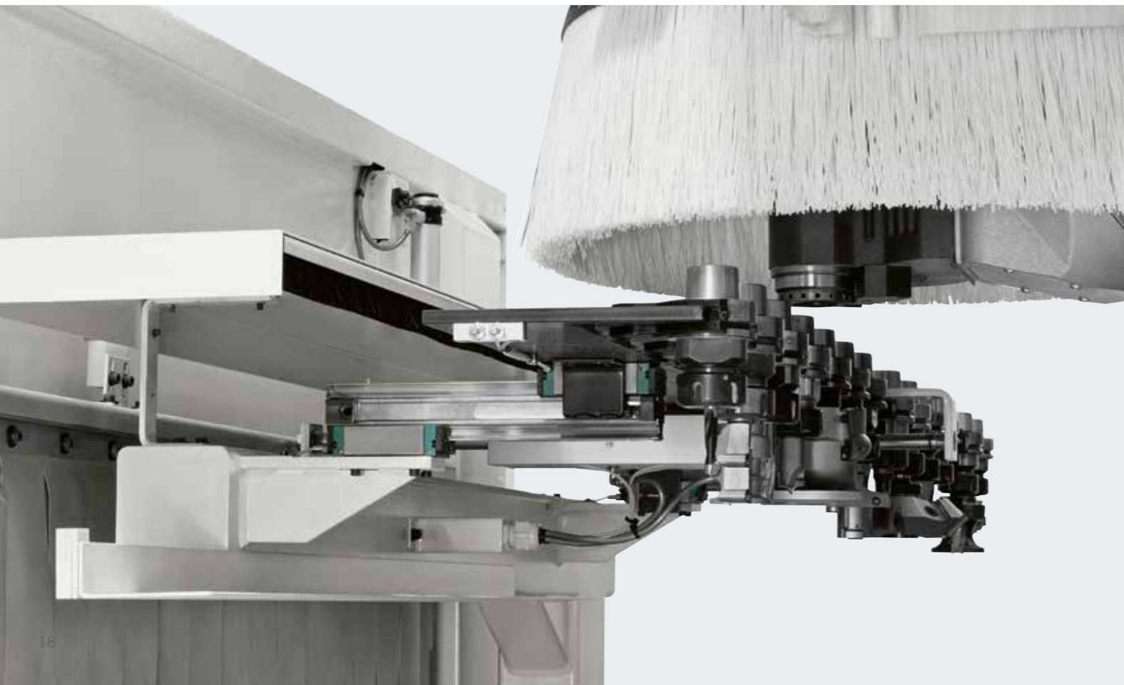
Magasin « Pick-up » à 1 position ancré sur la poutre mobile. Équipement idéal pour l'utilisation des outils et des têtes à renvoi angulaire de grandes dimensions.
