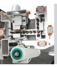
Dotation complète du groupe opérateur avec une tête de perçage pour les trous verticaux et horizontaux, une lame pour les rainures le long de l'axe X sur le panneau situé à l'arrière du meuble, et un électromandrin pour les fraisages de 5,5 kW à 18000 t/min.
