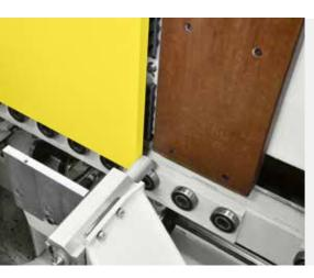
Haut niveau de flexibilité, la butée de référence programmable permet d'usiner des pièces même avec des tourillons déjà insérés ou des fraisages déjà exécutés.
