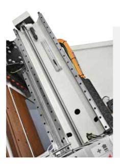
Haute précision et rapidité de mouvement, tous les groupes opérateurs sont actionnés par des moteurs brushless et coulissent sur des guides prismatiques avec des patins à billes. Le système de déplacement en X, Y, et Z se fait grâce à une vis à billes de haute précision.
