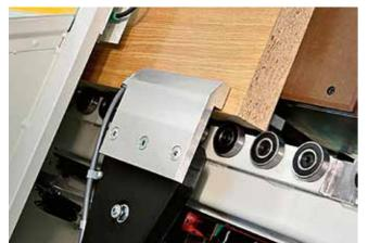
Très grande stabilité de la pièce et haute qualité d'usinage, avec la pince mobile, à ouverture flottante qui ne nécessite aucun réglage, et la table anti-éraflure en bakélite qui garantit une haute qualité d'usinage même pour les panneaux avec des surfaces délicates.
