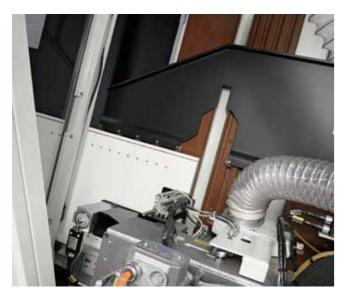
**Sécurité et fiabilité**, grâce au groupe presseur supérieur qui assure l'adhérence des pièces à la référence inférieure et garantit la plus grande précision d'usinage.
