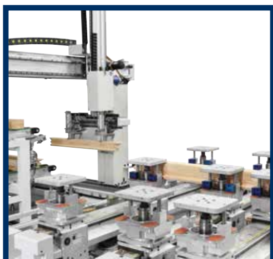
Cellule d'usinage flexible pour la fabrication de menuiseries et portes, équipée d'un système de chargement et déchargement automatique.
