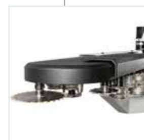
Magasin à chaîne à 32 positions ancré au portique mobile, conçu pour la gestion d'outils lourds et de grandes dimensions.
