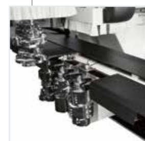
Magasin à chaîne à 48 positions ancré au portique mobile, conçu pour la gestion d'outils lourds et de grandes dimensions.
