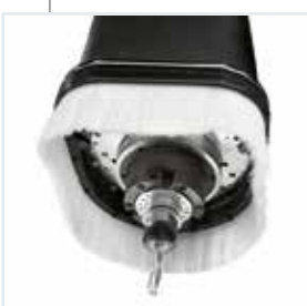
Unité de fraisage arrière avec électrobroche à 3/4 axes.
