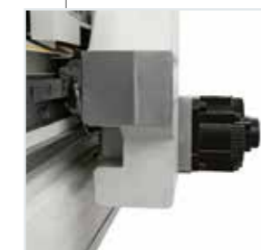
Absence totale de vibrations même à vitesse élevée avec la structure à portique qui se déplace grâce à un double moteur.
