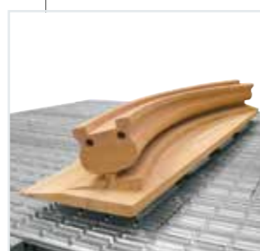
Plan de travail multifonction adapté à toutes les exigences de référence et de blocage de la pièce.
