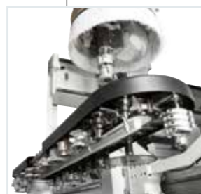
Magasin à chaîne à 48 positions ancré au portique mobile, conçu pour la gestion d'outils lourds et de grandes dimensions.
