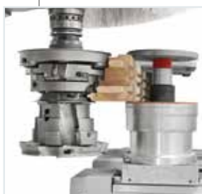
Plan de travail d'une hauteur de 145 mm (H145) pour usiner des éléments de différentes épaisseurs avec des outils à double profil.
