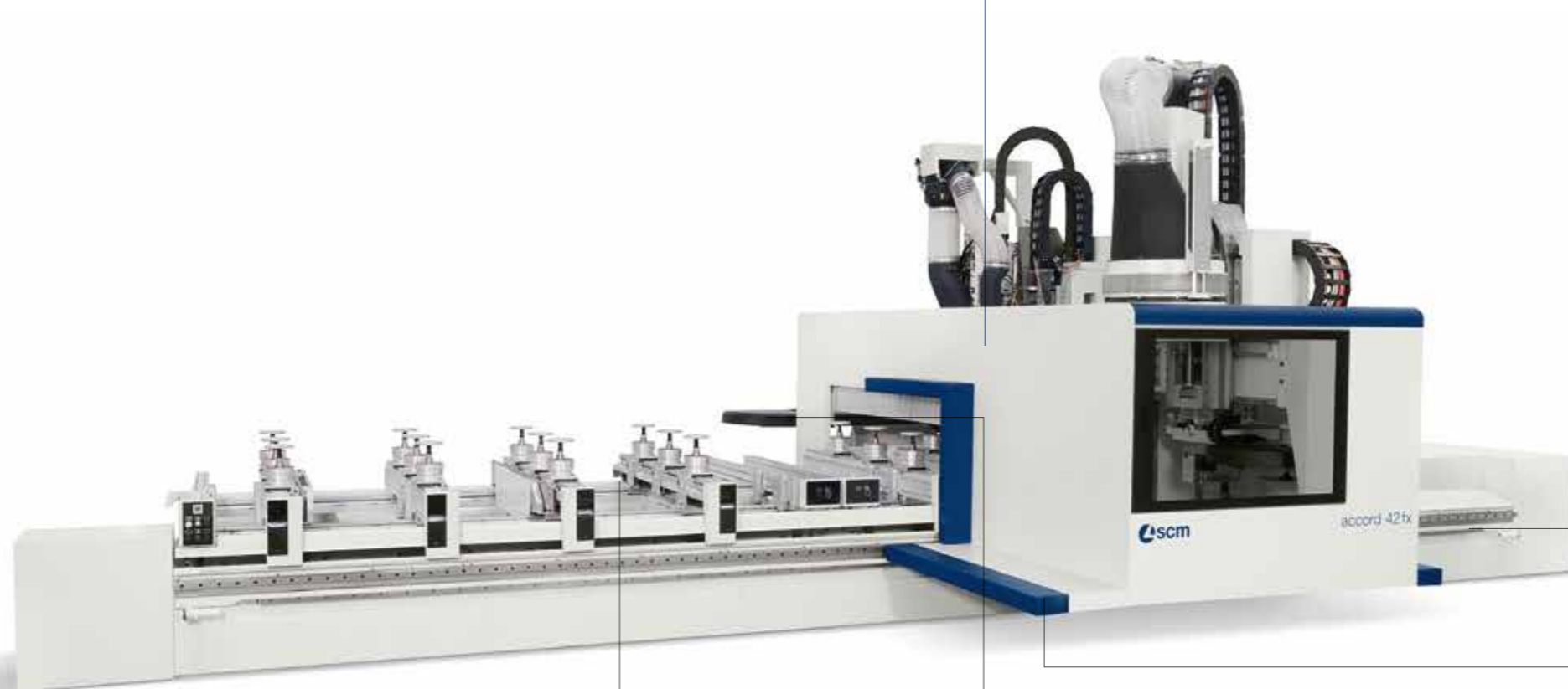
Unité de fraisage arrière avec électrobroche à 3/4 axes.
