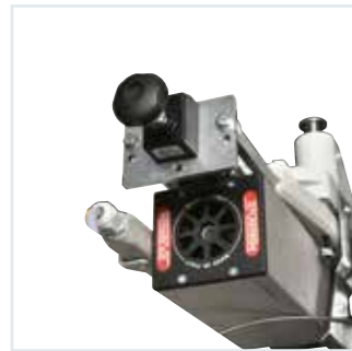
Groupe toupie T-M pour l'exécution de rainures sur le côté supérieur du panneau
