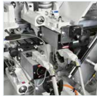
Groupe d'affleurage R-M: changement d'usinage rapide entre chant mince, épais et chant massif
