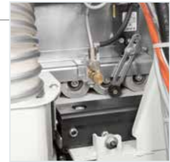
Groupe anti-adhérent AAL: propreté optimale du panneau avec la vaporisation du liquide antiadhésif.
