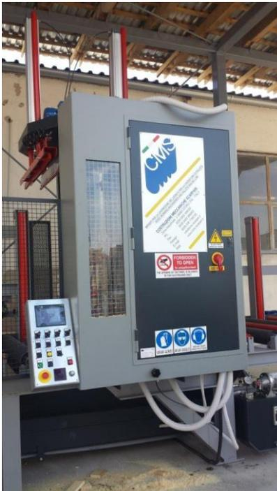
L'unité de sciage est complètement protégée. Le côté d'entrée et de sortie sont pourvus d'un rideau de protection automatique. Ceci descend automatiquement pour la découpe.
