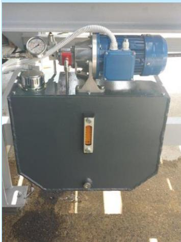
Centrale de lubrification automatique pour la chaîne.
