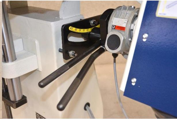
**L'unité de ponçage est réglable à onglet jusqu'à 45 degrés**
