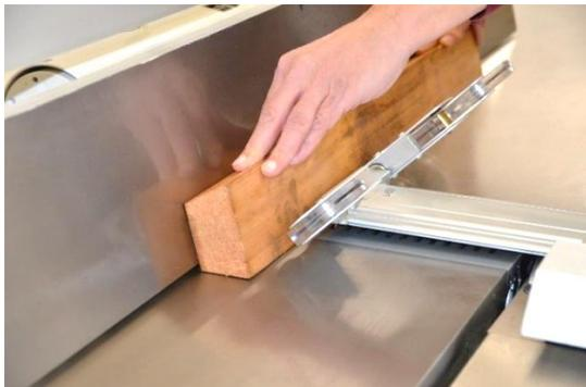
Le Smartlifter peut être positionné pour raboter des **pièces à biseaux**.
