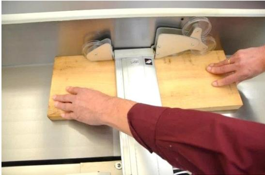
Le Smartlifter se positionne **verticalement** selon l'épaisseur de la pièce.
