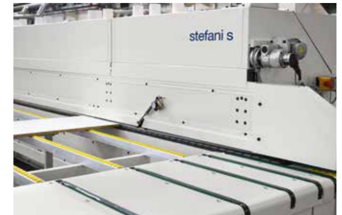
Système d'introduction automatique à l'entrée de la machine et transfert mono/multi-courroies en sortie pour l'intégration avec la manutention en amont et en aval
