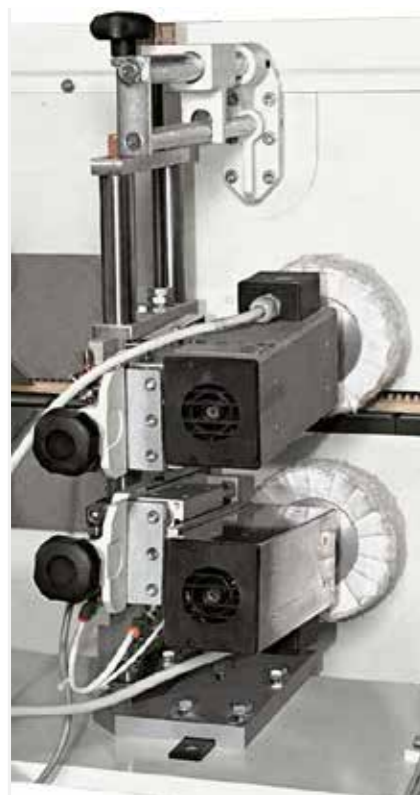
Dispositif à brosses rotatives pour le ravivage et le nettoyage final du chant appliqué.
