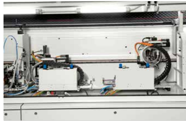
GRUPE ARRONDISSEUR À 2 MOTEURS SERVO-ASSISTES
