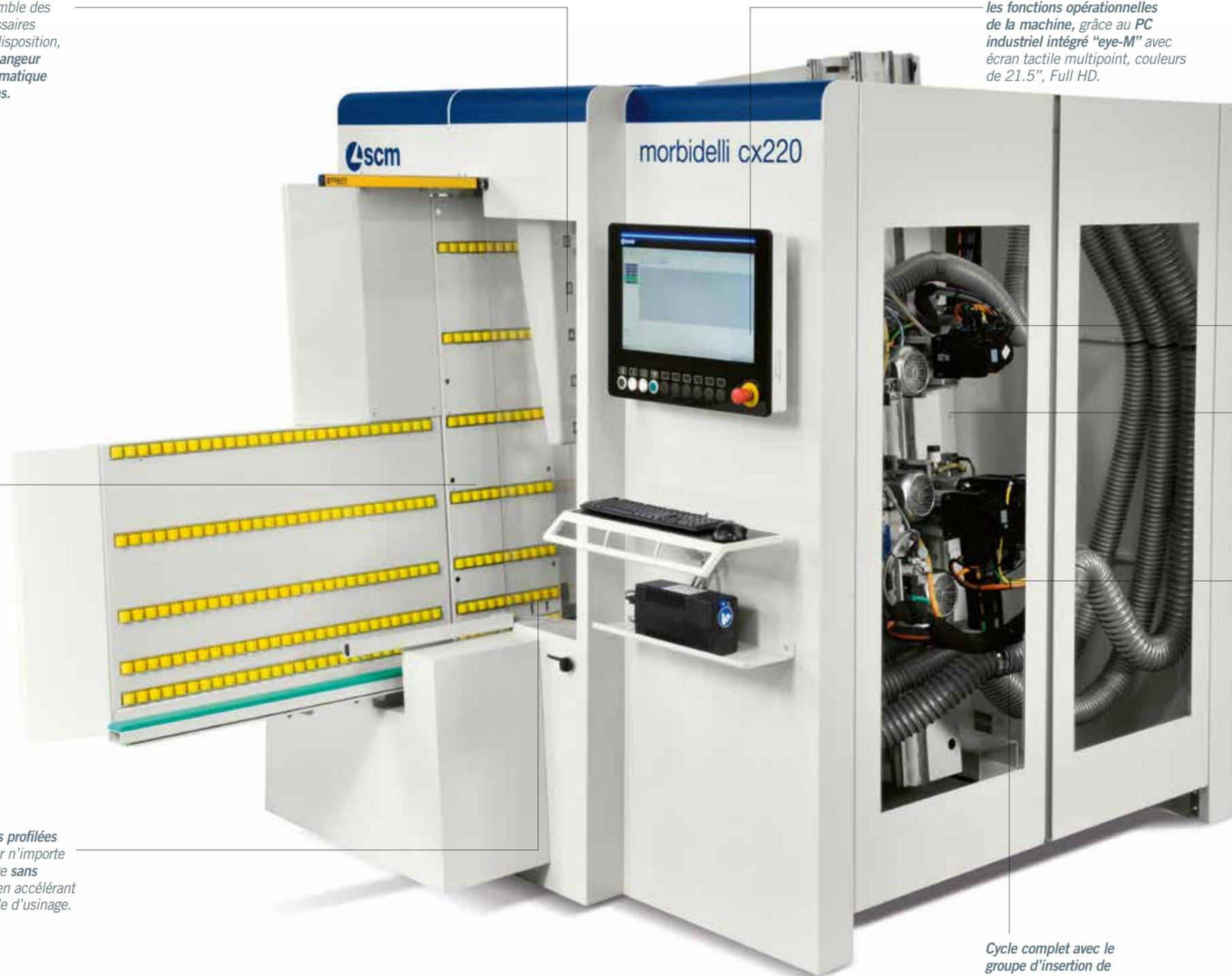
*Gérer d'une seule pression toutes les fonctions opérationnelles de la machine, grâce au PC industriel intégré "eye-M" avec écran tactile multipoint, couleurs de 21.5", Full HD.*
