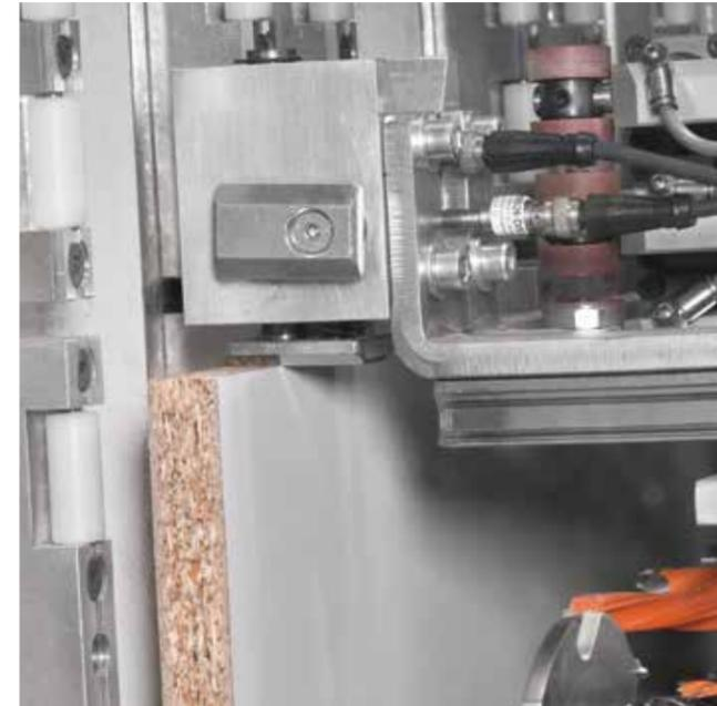
**AUCUN RISQUE D'ERREUR AVEC "3D PROBE"**, le système de mesure adaptative pour la longueur, la largeur et l'épaisseur du panneau.
