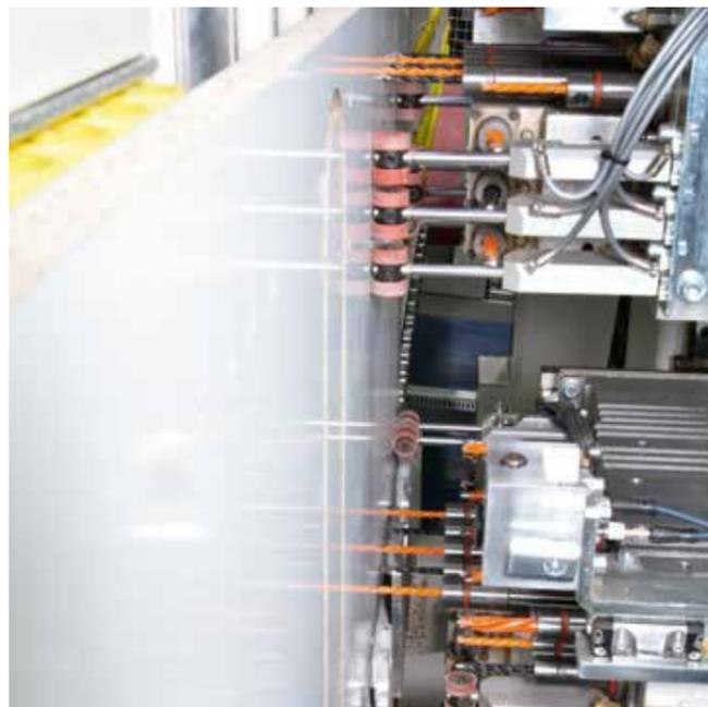
Jusqu'à 55 mandrins RO.AX (mandrin à technologie rotoaxiale) installés sur la double tête de perçage pour réaliser tous les perçages sans nécessiter d'intervention de l'opérateur.
