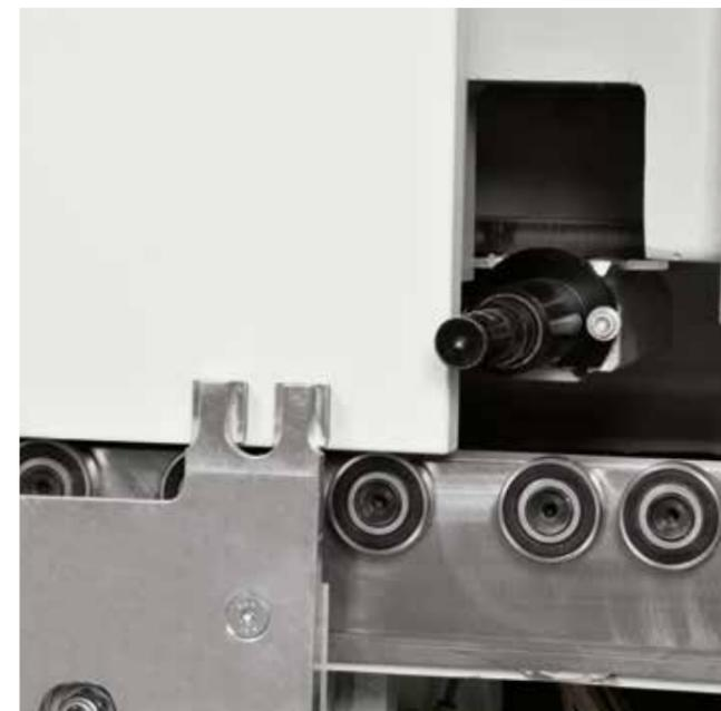
Chargement rapide et précis des panneaux: **butée mécanique de référence programmable.**
