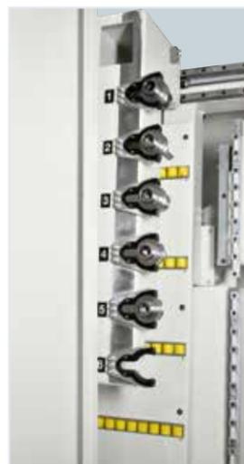
*Flexibilité maximale avec l'ensemble des outils nécessaires toujours à disposition, grâce au changeur d'outil automatique à 6 positions.*
