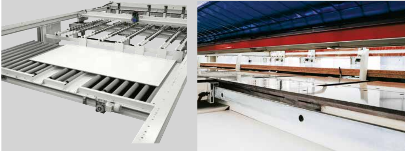
Aligneurs frontaux pour le chargement automatique.
