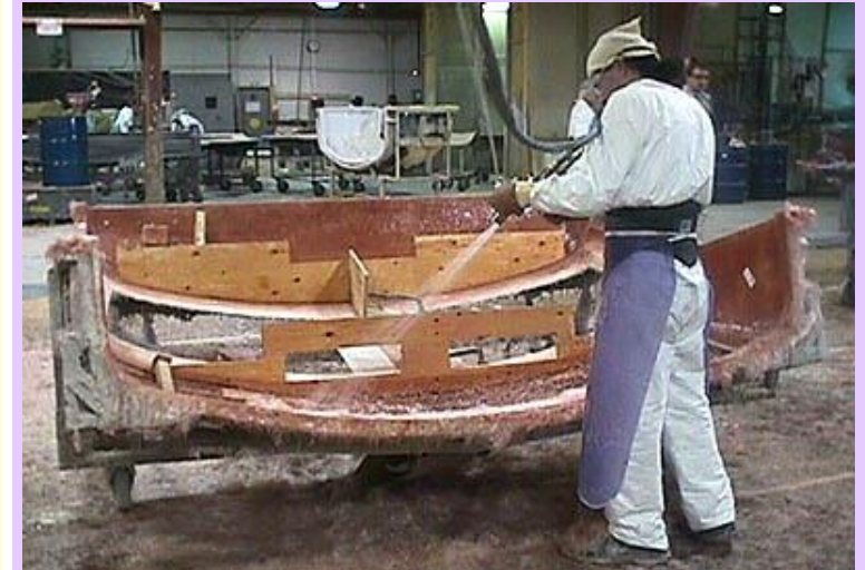
Foto: voorbeeld van een spuitlaminatietechniek
