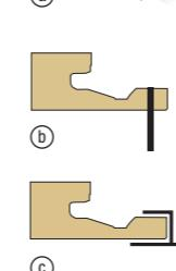
De lange zijden van de panelen beschikken over een gepatenteerd kliksysteem. (a) De panelen worden bevestigd met nietjes of met onze Plano-clips 1513. (b-c) **Let wel:** voor ruimtes langer of breder dan 5m wordt het gebruik van clips sterk aangeraden. De clips kan men nieten, alsook vijzen waardoor de panelen bevestigd kunnen worden op een metalen kader.
