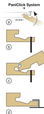
① ② De lange zijden van de panelen beschikken over een gepatenteerd kliksysteem. De panelen worden bevestigd met nietjes, met onze Plano-clips 1513 of met een montagelijn.
