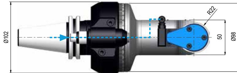
Senso di rotazione Contrario al mandrino - Direction of rotation Opposite to the machine spindle
