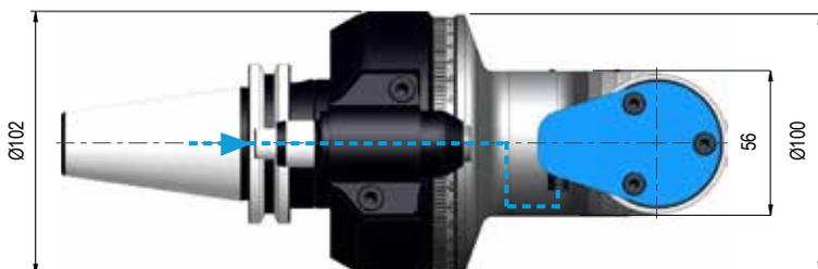
Senso di rotazione Contrario al mandrino - Direction of rotation Opposite to the machine spindle
