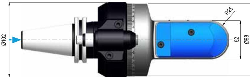
Senso di rotazione Contrario al mandrino - Direction of rotation Opposite to the machine spindle
