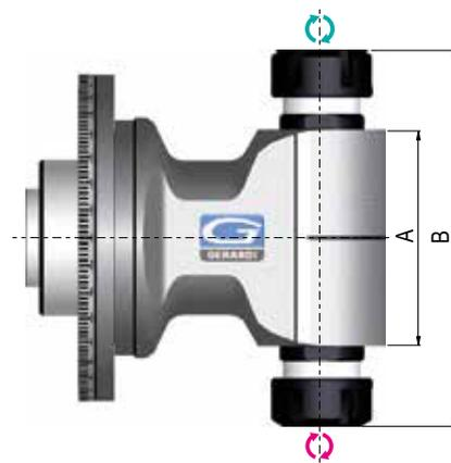
Teste angolari MTC doppia uscita - Double output MTC angle heads
