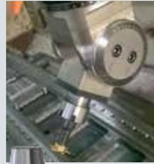
Operazioni orizzontali, verticali e angolari con una sola testa. Uscita completamente regolabile con angolazione  $\pm 90^\circ$
