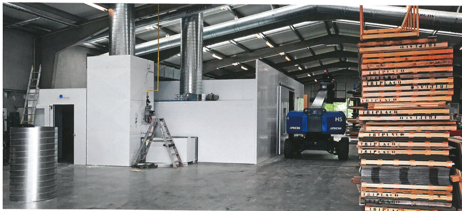
Minus koos voor een spuitdroogcabine met verwarming die toelaat om de producten tegelijkertijd te behandelen en te drogen.
