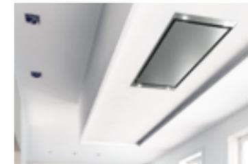
L'angle d'évasement des vapeurs se situe entre 10° et 15°. Pour un fonctionnement optimal, il est important que la dimension de la construction dans laquelle le plafonnier est installé couvre au moins la largeur et la profondeur de la plaque de cuisson ainsi que l'évasement des vapeurs: un débord d'environ 30 cm est conseillé. Faire un avaloir de 10 cm autour du coffrage permettra également de bloquer les vapeurs.
