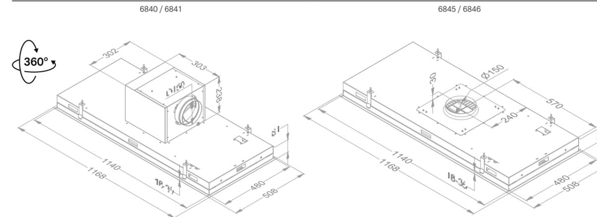
(1) La hotte doit être connectée avec le moteur dissocié extérieur 445.999 ou un moteur extérieur pour toiture plate (voir accessoires). Le débit d'air et le niveau sonore dépendent de l'installation.
