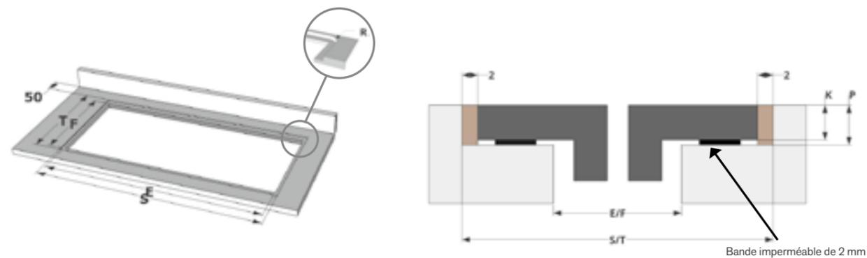
(2) Pour assurer une ventilation et une évacuation optimales de la chaleur de l'appareil, un espace d'air doit être aménagé entre le plan de travail et le tiroir.
