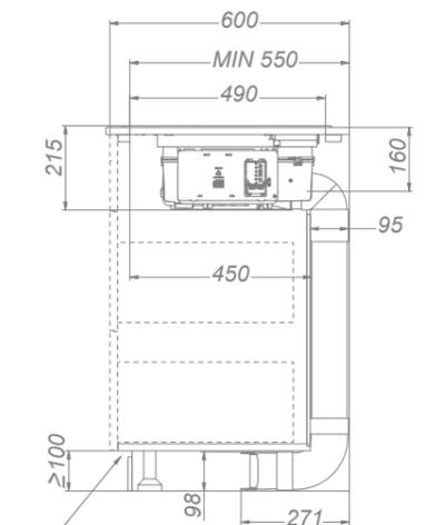
Surface d'ouverture minimale 550cm<sup>2</sup> pour le renvoi de l'air dans la pièce
