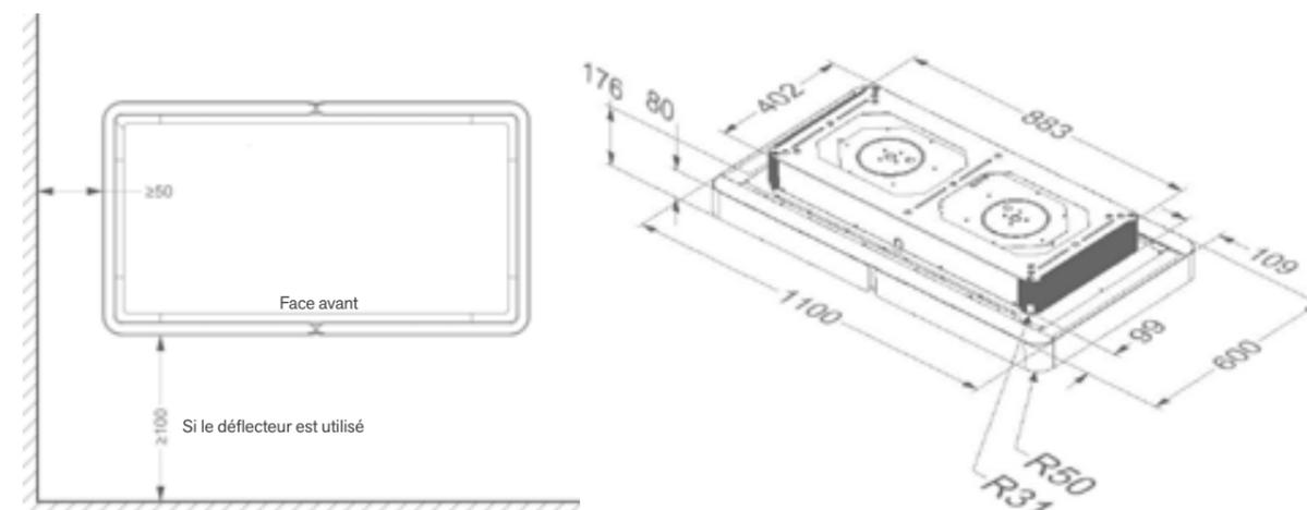
La distance entre le côté gauche et/ou le côté droit du Cloud et le mur ou la fenêtre ne doit pas être inférieure à 50 cm.
